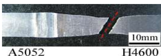
図19 チタン母材で破断した異材継手試験片
