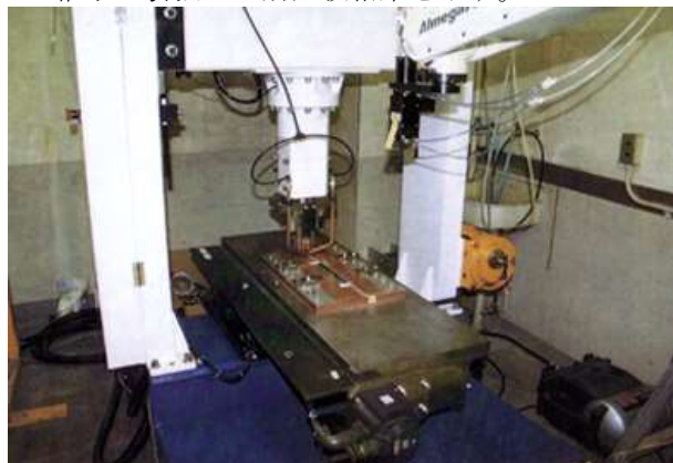
図17 開発したレーザーロール溶接装置
